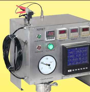
Испытательное оборудование для многократного и постоянного измерения максимальной длины соединительных трубок воздушного выключателя в зависимости от объема кнопки и развиваемого ею давления (лаборатория Ultimheat)
